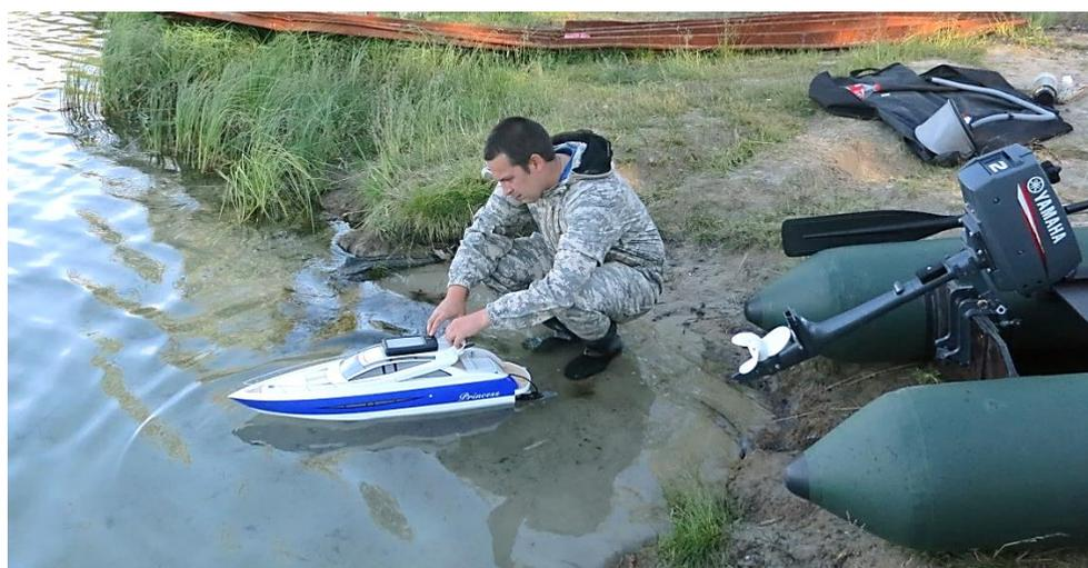
Рис. Радиоуправляемая модель яхты с автоматическим батиметрическим комплексом
